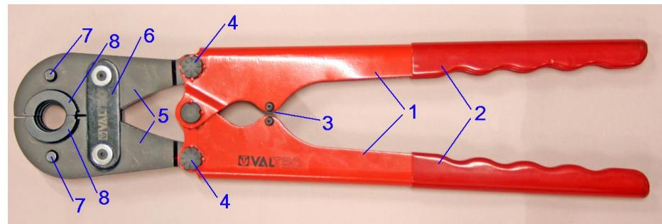
Монтажное усилие, приложенное к рукояткам (1) по принципу рычага передается на полуобоймы (5), в которых закрепляются пресс-вкладыши (8). Вкладыши фиксируются кнопочными фиксаторами (7). Планка (6) стягивает промежуточные осевые втулки. Ролики (3) предохраняют упоры рукояток от смятия. На рукоятках имеются защитное покрытие из ПХВ (2), предохраняющее руки при монтаже. Осевыми эксцентриками (4) можно корректировать настройку пресс-клещей в случае появления чрезмерных люфтов (см. раздел 4).
